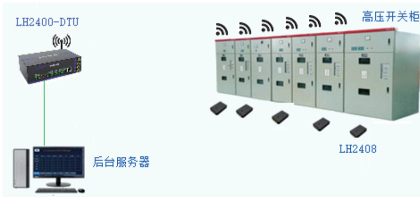
图7-1 LH2408构成开关柜局放在线监测系统——无线组网
