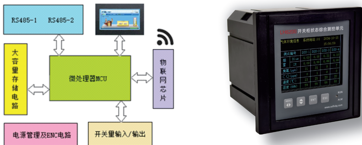
图2-1 LH6200装置及原理框图
