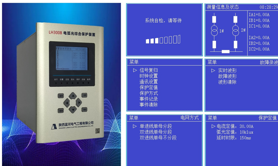
图3-4 LH300B专用控制器及相关界面示意图
